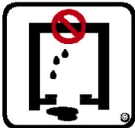
НЕ ИСПОЛЬЗУЙТЕ ПОДЪЕМНИК, ЕСЛИ ОБНАРУЖЕНА УТЕЧКА ЖИДКОСТИ ИЗ ГИДРАВЛИЧЕСКОЙ СИСТЕМЫ.
