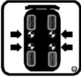
ИСПОЛЬЗУЙТЕ ТОЧКИ ПОДЪЕМА ТРАНСПОРТНОГО СРЕДСТВА, ОБОЗНАЧЕННЫЕ ПРОИЗВОДИТЕЛЕМ.
